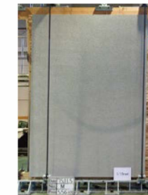
モルタル壁 (断熱材なし)
