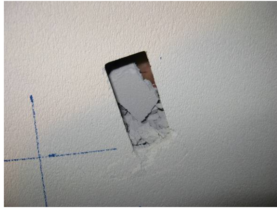
(16) 試験体 No.6, ミサイル C の衝突痕
