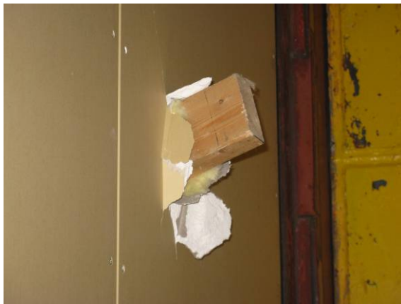
(3) 内装材への貫通 (試験体 No.1)
